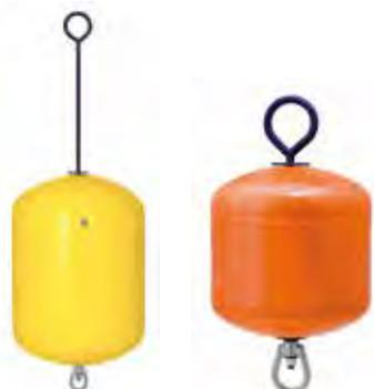
La bouée MB est fabriquée par un système de roto-moulage en matière polyéthylène (PE) et remplie avec la mousse polystyrène (EPS). Cette fabrication procure une très grande résistance à la compression des bouées. Destinée aux mouillages, piscicultures et industries.
