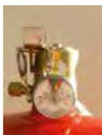
Extincteurs à gaz inerte, DuPont FE-227TM, remplaçant le gaz Halon pour une installation fixe. Système conçu pour tous types de bateau, décharge automatique et manuelle pour protéger un compartiment moteur de 1.4 m<sup>3</sup> à 42.5 m<sup>3</sup> Propriétés du gaz : Extinction rapide d'un foyer par refroidissement jusqu'à l'arrêt de la combustion. Peut éteindre un feu en moins de 10 secondes.
