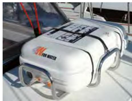
Support pouvant être fixé sur le pont ou le balcon, il permet de maintenir et de positionner dans un endroit pratique et accessible votre radeau. Réglable en longueur et en largeur, il est fabriqué en aluminium ou en inox. La boucle de fermeture est en inox et les sangles sont réglables. Peut se placer horizontalement ou verticalement.
