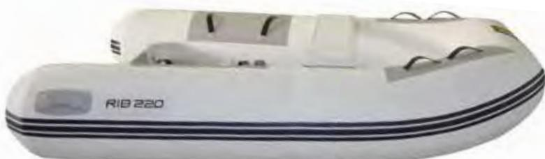
Gamme d'annexe semi-rigide. Carène polyester en V, rapide et confortable. Cette annexe peut être montée sur bossoirs. Double coque et plancher plat sur le modèle RIB 220
