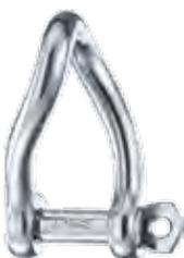
En fin de vissage, l'élasticité du corps de la manille bloque la tête du manillon dans l'un des crans, afin d'éviter un dévissage intempestif.
